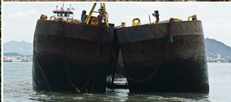
Foto Superior: Construcción de espigón para desembarque de roca en Vacamonte. Abajo" Barcaza de fondo partido abierta.
